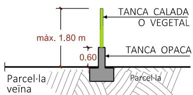
Les tanques opaques no podran ultrapassar l'alçada de 0,60 metres mesurats des de la cota natural del terreny en la partió amb el veí i fins màxim de 1,80 metres, calat o vegetal.
