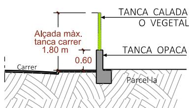
Tanques opaques fins una alçada de 0,60 m. Calades o vegetals fins un màxim de 1,80 metres, mesurats des de la rasant del carrer.
